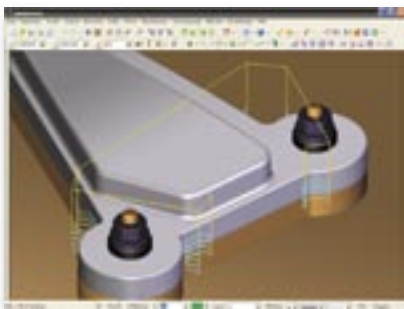
Automatisierte Kontur-Restmaterialbearbeitung mit einem kleineren Werkzeug
