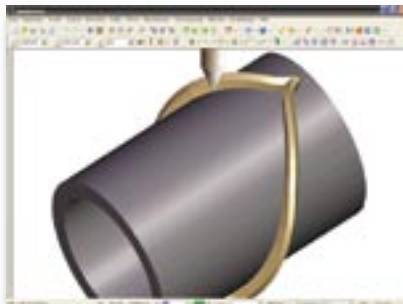
4-Achsen-Endfräsen speziell für Walzen und vertikale Wände an zylindrischen Teilen
