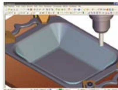
Fräsen von Taschen mit konischen Wänden
