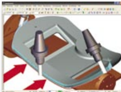
Wälzfräsen mit Führungskonturen
